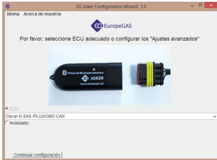
Fig. 8: Ventana de selección del tipo de ECU. 1 – Selección para la EG Joker que debe ser configurada, 2- Modo de conexión propuesta, 3 – Opciones avanzadas, 4- Botón para continuar con el proceso de configuración.
