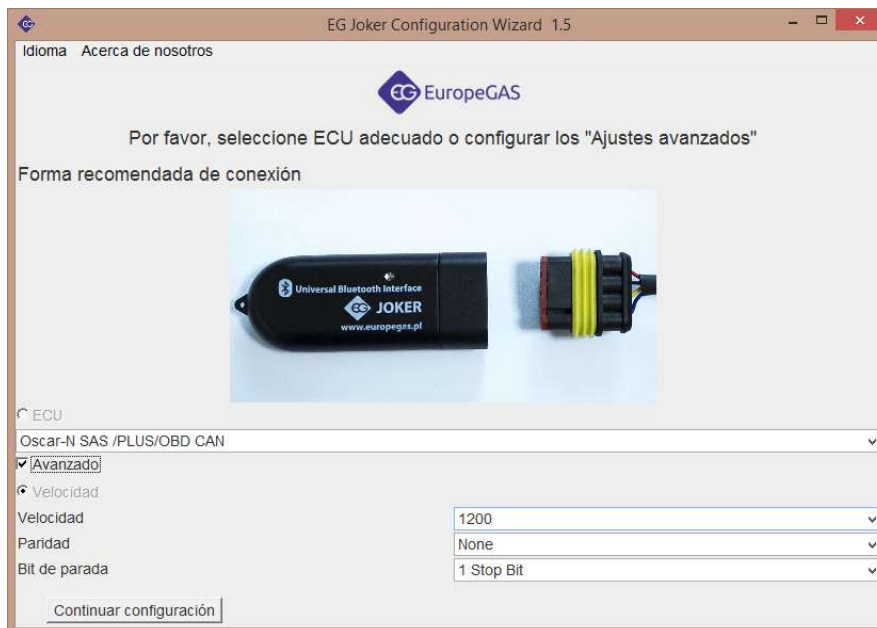
Fig. 9: Opciones avanzadas. 1 – Selección de la velocidad de transmisión de la interfaz, 2 – Selección de paridad (Ninguna, Par, Impar), 3 – Número de bit de parada.
